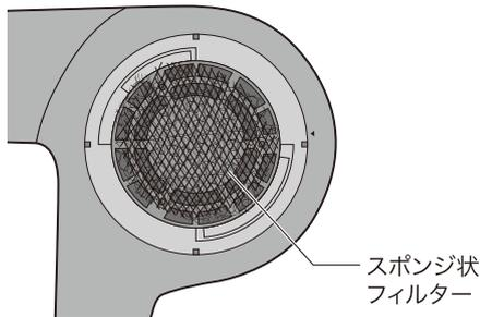
② 金属状のフィルターの凸部を下図のように設置する。
