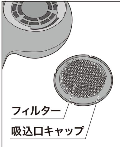
**吸込口** ※吸込口キャップは左に回すと簡単に取り外せます。
