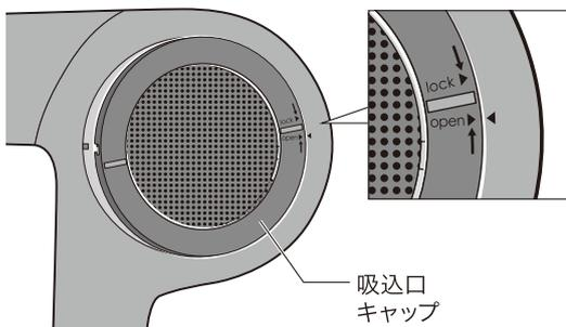
④ 吸込口キャップ「lock」の▶と本体の◀がカチッと音がするまで右に回す。
